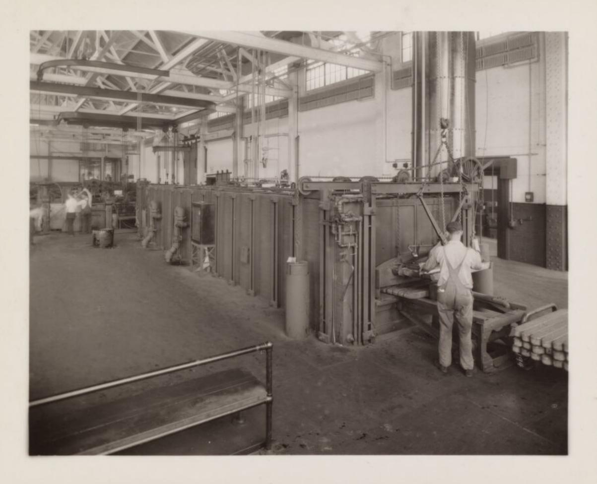
ROD MILL BILLET HEATING FURNACE
