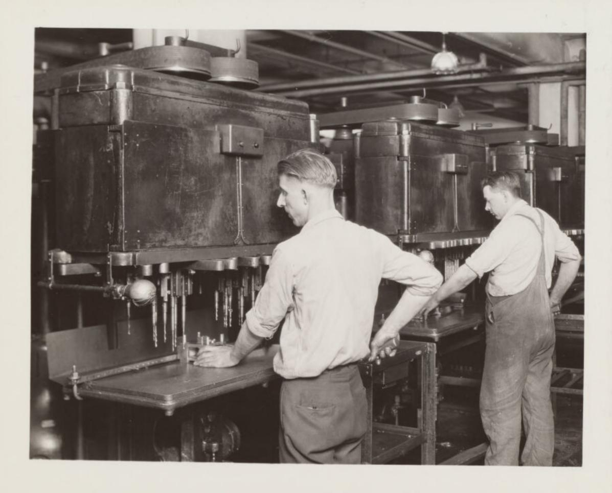
DRILLING JACK STRIP ON 24-SPINDLE DRILL PRESS
