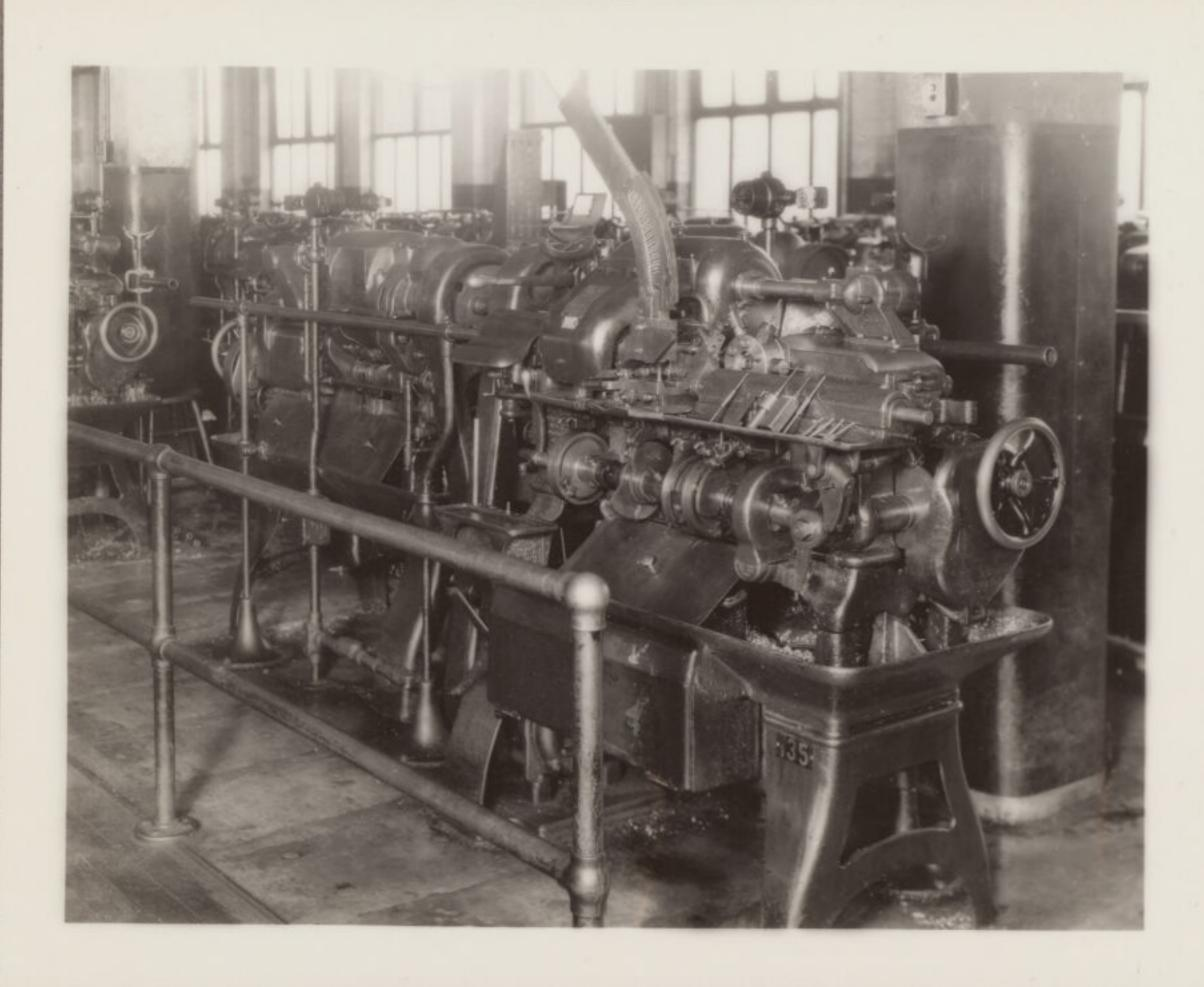
AUTOMATIC SCREW MACHINE SHOWING MAGAZINE FEED FOR PLUG BODIES
